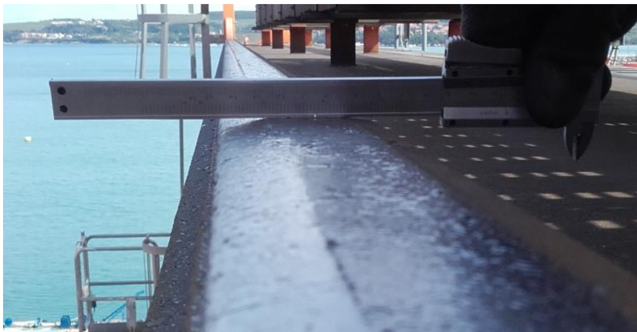
Slika 1: Močno obrabljena tirnica na RTG dvigalu
