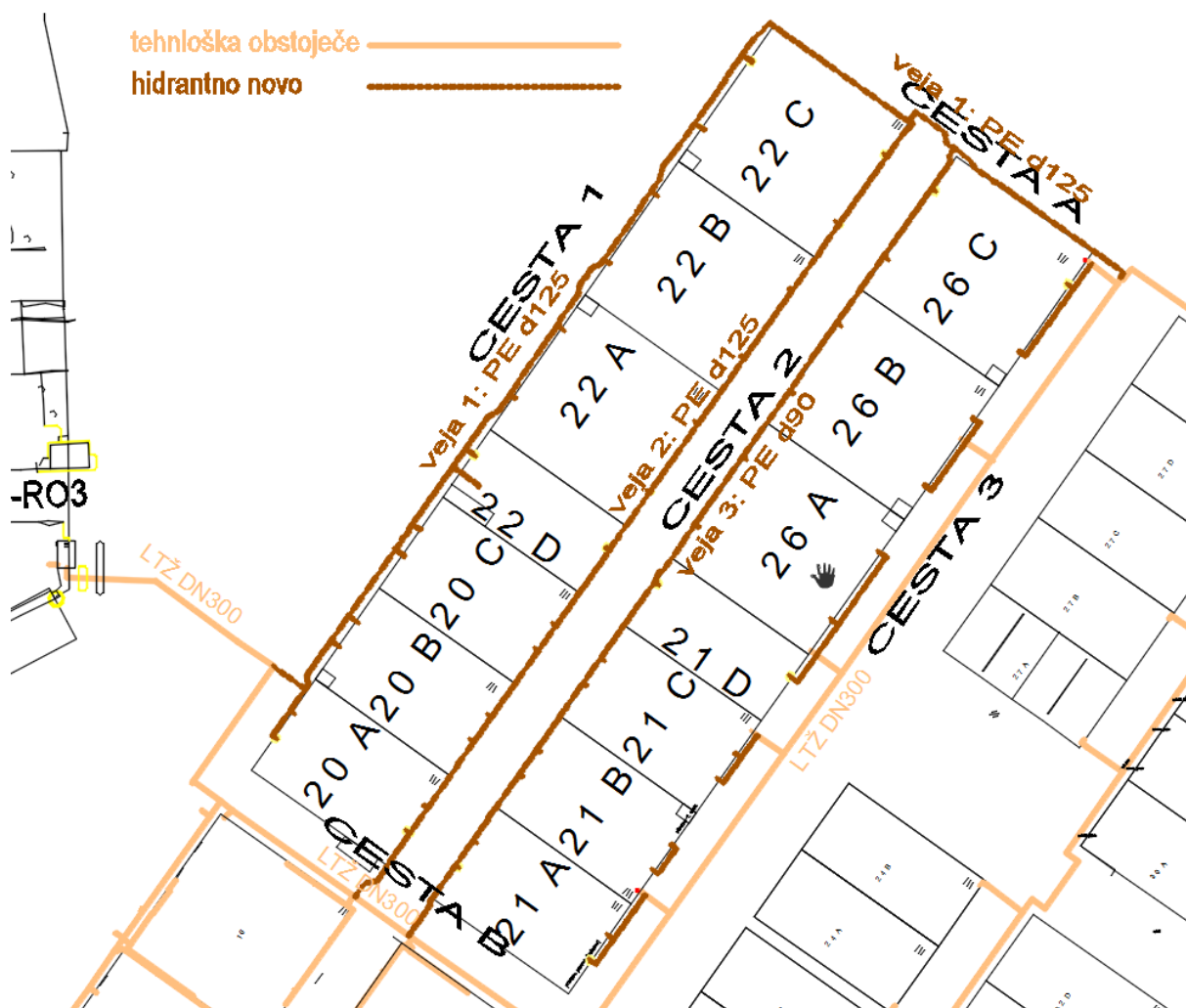
SLIKA 2: SITUACIJA PREDVIDENEGA HIDRANTNEGA OMREŽJA
