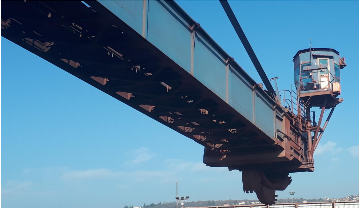
Slika 2: Kabina z vpetjem ter mehanizmom za nagibanje kabine
