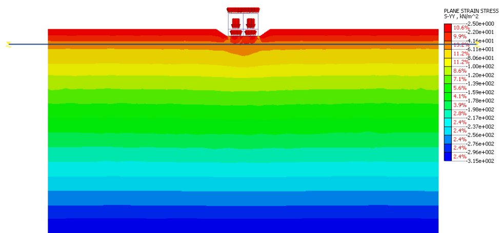
Slika 6: Napetost \sigma_{zz} [kN/m 2 ], končno stanje – po 5 računski fazi
