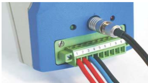
Priključki vhodnih merilnih kanalov in serijskega PC vhoda
