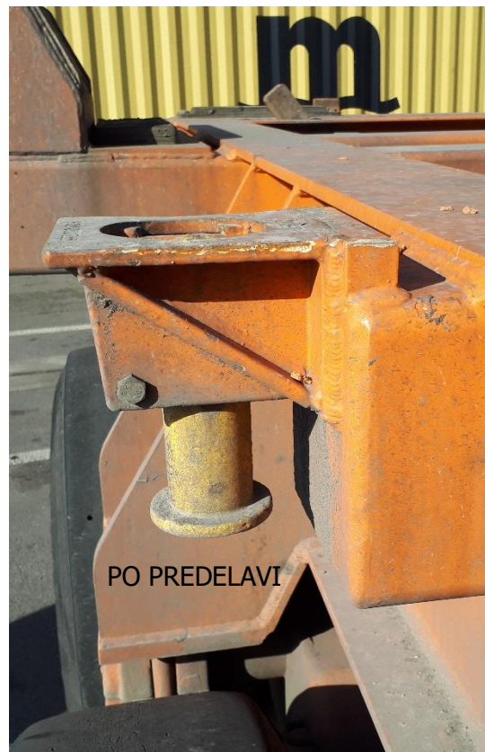
Slika 2: Sprememba višine trnov za vpetje tank kontejnerjev (točka 2)
