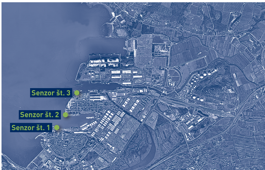
Slika 44: Senzorji za zaznavanje morebitnih razlitij naftnih derivatov
