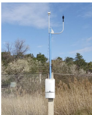
Slika 30: Merilna mesta ter sodobne merilne naprave za izvajanje kontinuiranih meritev hrupa
