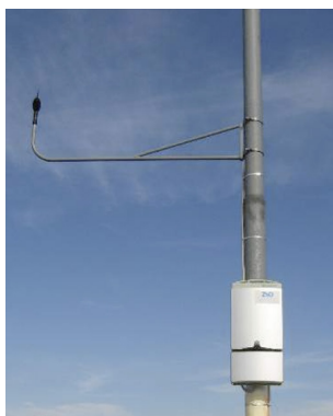
Slika 30: Merilna mesta ter sodobne merilne naprave za izvajanje kontinuiranih meritev hrupa
