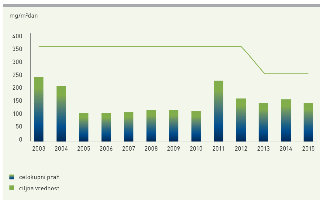
Slika 14: Povprečne letne količine celokupnega praha vseh merilnih mest znotraj pristanišča
