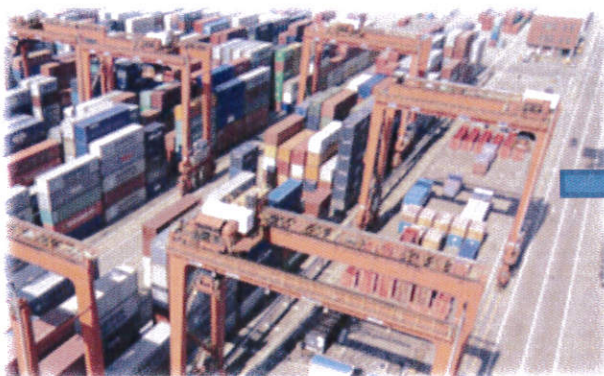
Slika 30. Transtejnerji na Kontejnerskem terminalu na diesel pogon
