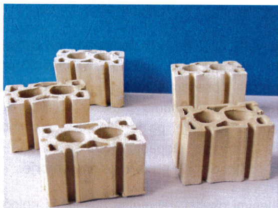
Slika 36. Laboratorijska opeka izdelana izključno iz morskega sedimenta
