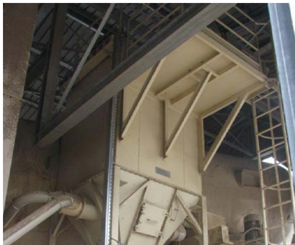
Slika 16: Filtrirni sistem za pretovor soje
