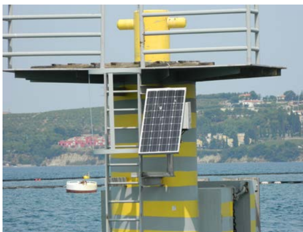
Slika 46: Ena od naprav za zaznavanje morebitnih razlitij v morju
