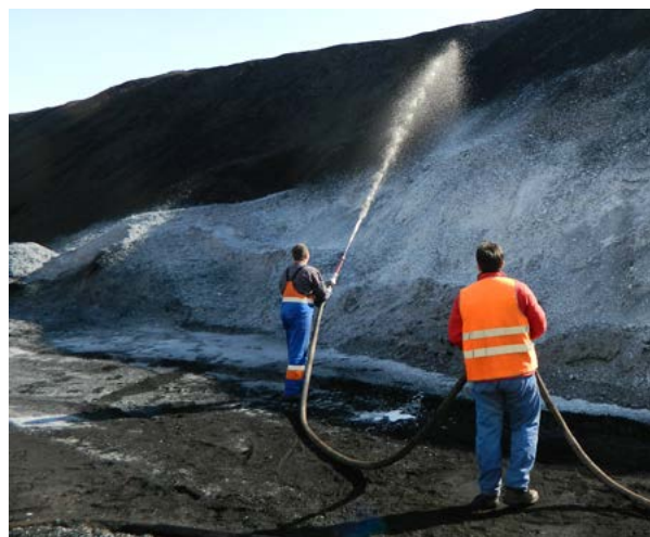
Slika 19: Poskusno testiranje nanosa papirniškega mulja na premogovni deponiji v Lukki Koper
