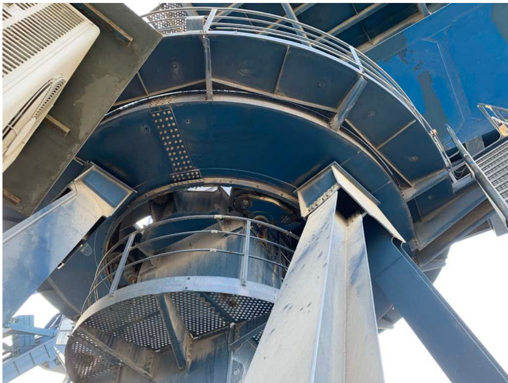
Slika 19 – spodnja stran podpornega venca.
