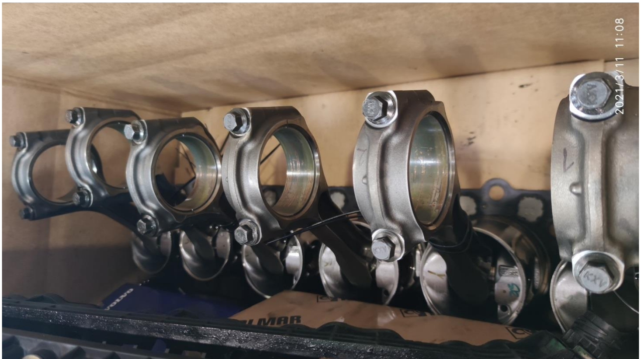
Slika 2: Poškodovani ojnični ležaji
