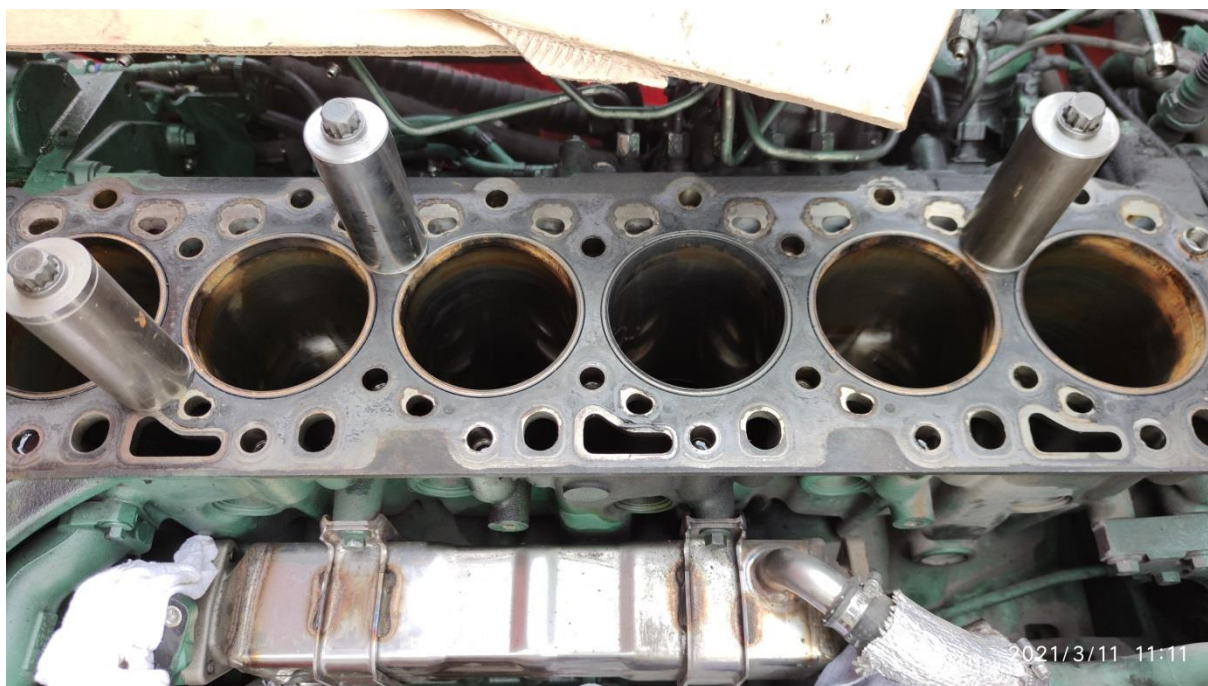
Slika 1: Demontirana glava in ojnice z bati
