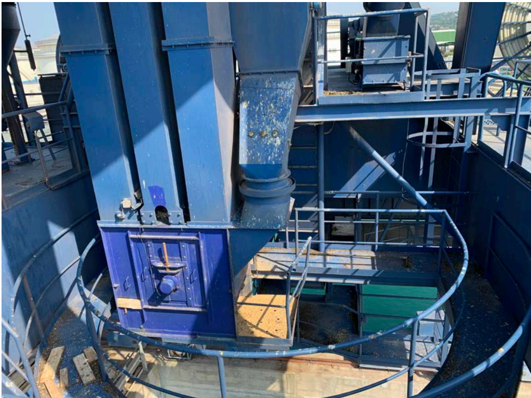
Slika 6 – krožni podest in spodnja stran vrtljivega dela prekladalca.
