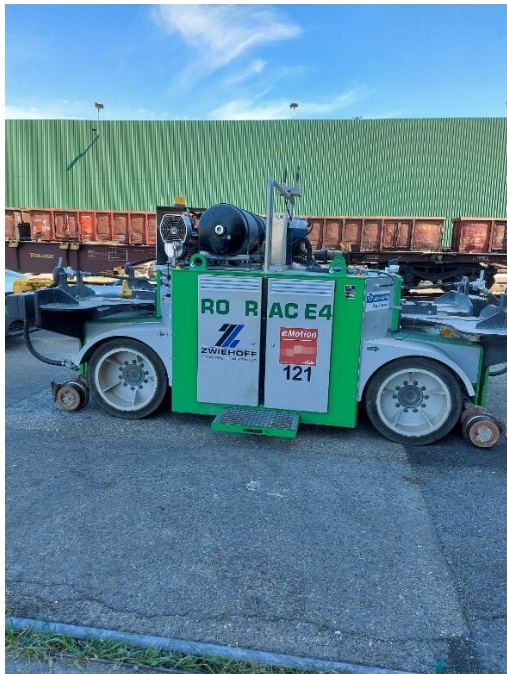
Slika 1: Elektro dvopotno cestno železniško vozilo za premik vagonov
