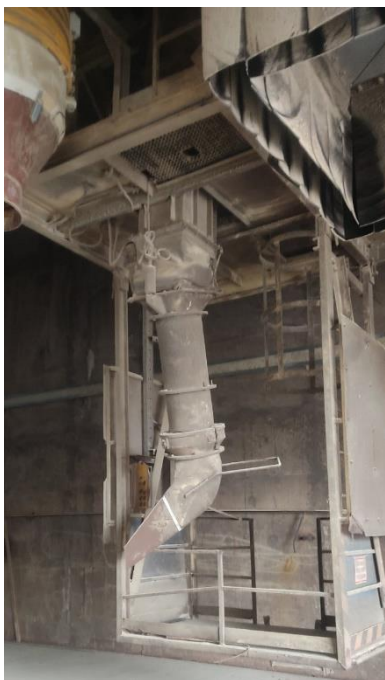
Slika prikazuje dostopno konstrukcijo z delom cevovoda za polnjenje s strani.
