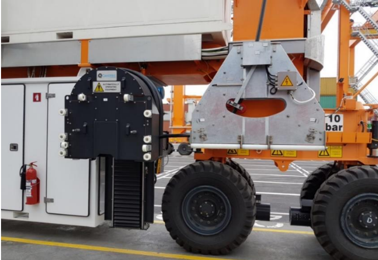
Slika 13: E-RTG dvigalo z APS sistemom
