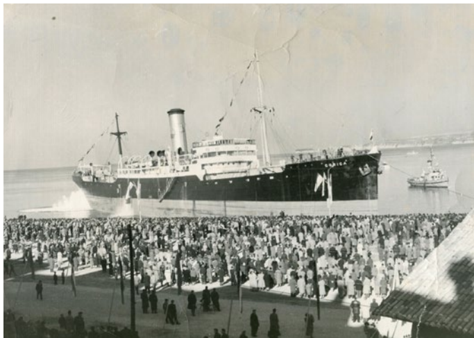
7. 12. 1958: Gorico je poganjal 4-batni parni stroj, dosegala je hitrost devet vozlov, nosilnost ladje je bila slabih 6 ton, njen ugrez pa 7 metrov.
