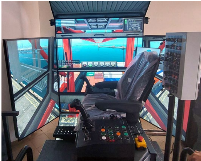
Med sofinanciranimi orodji v okviru projekta Luka.DT je bil tudi simulator za uvajanje, usposabljanje in preverjanje znanja upravljalcev luške mehanizacije. Simulator lahko uporabljamo za več vrst luške mehanizacije (obalno dvigalo, RTG, RMG, viličarji in drugi stroji).
