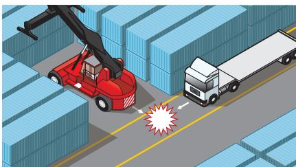
Med manipulacijo ima stroj prednost. V primeru vožnje v bližini strojev s hupo opozorite na prisotnost!
