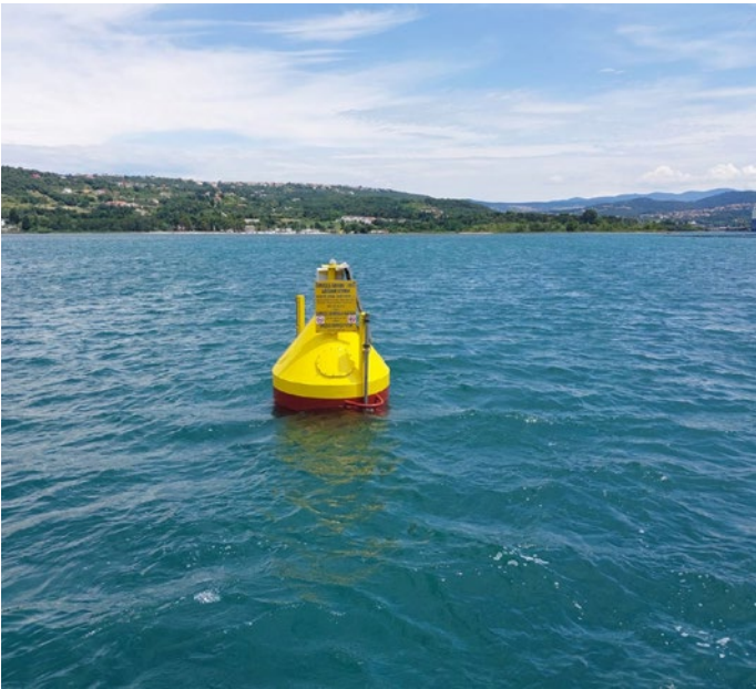
Na rumeni boji, ki plava pred vstopom v luške bazene, so nameščeni merilniki za kvaliteto morske vode in tokomer.
