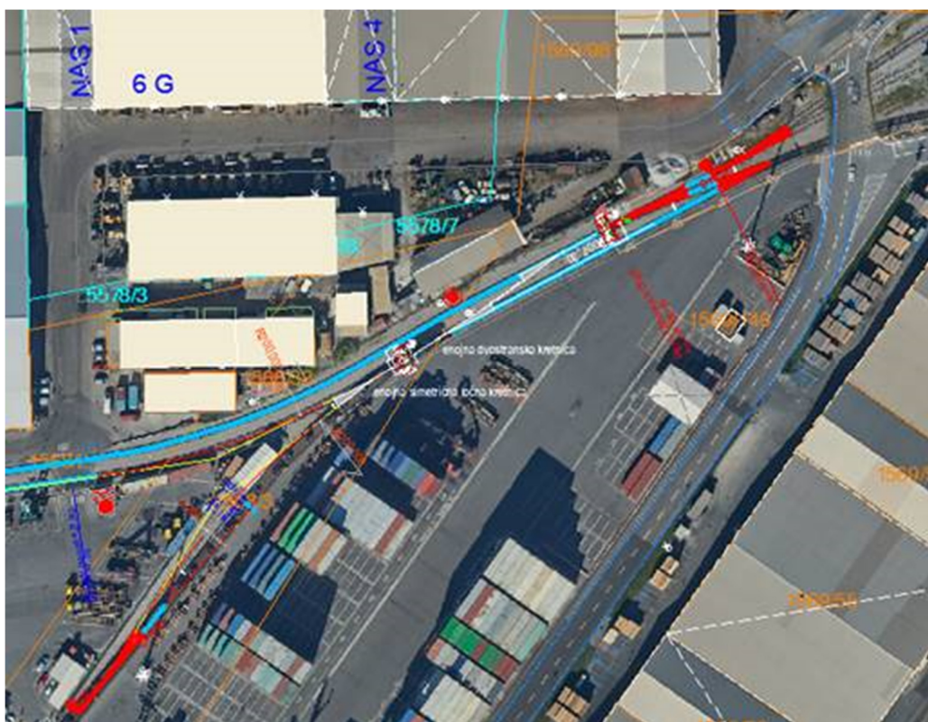
Slika 1: Prikaz umeščenosti kretniške zveze med tiroma 25c in 1f
