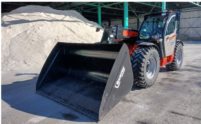
Teleskopski viličar Manitou za manipulacijo različnih materialov na Centru za zbiranje odpadkov Inpo.
