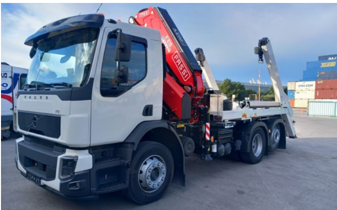
Komunalno vozilo Volvo s samonakladalcem Hyva in avtodvigalom Fassi za prevoz zabojnikov za odpadke.
