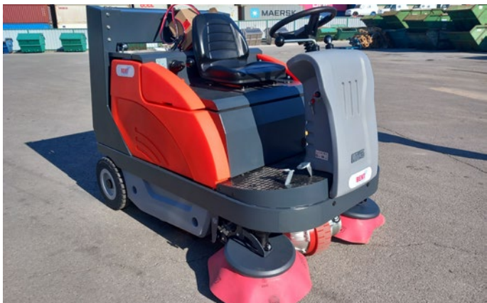
E-pometalni stroj HAKO za čiščenje utesnenih skladiščnih površin, površin v garažni hiši in večnadstropnih stavb.
