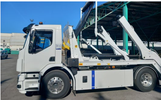
E-komunalno vozilo Renault za odvoz komunalnih odpadkov z vgrajeno tehniko in hidravličnim dvigalom.
