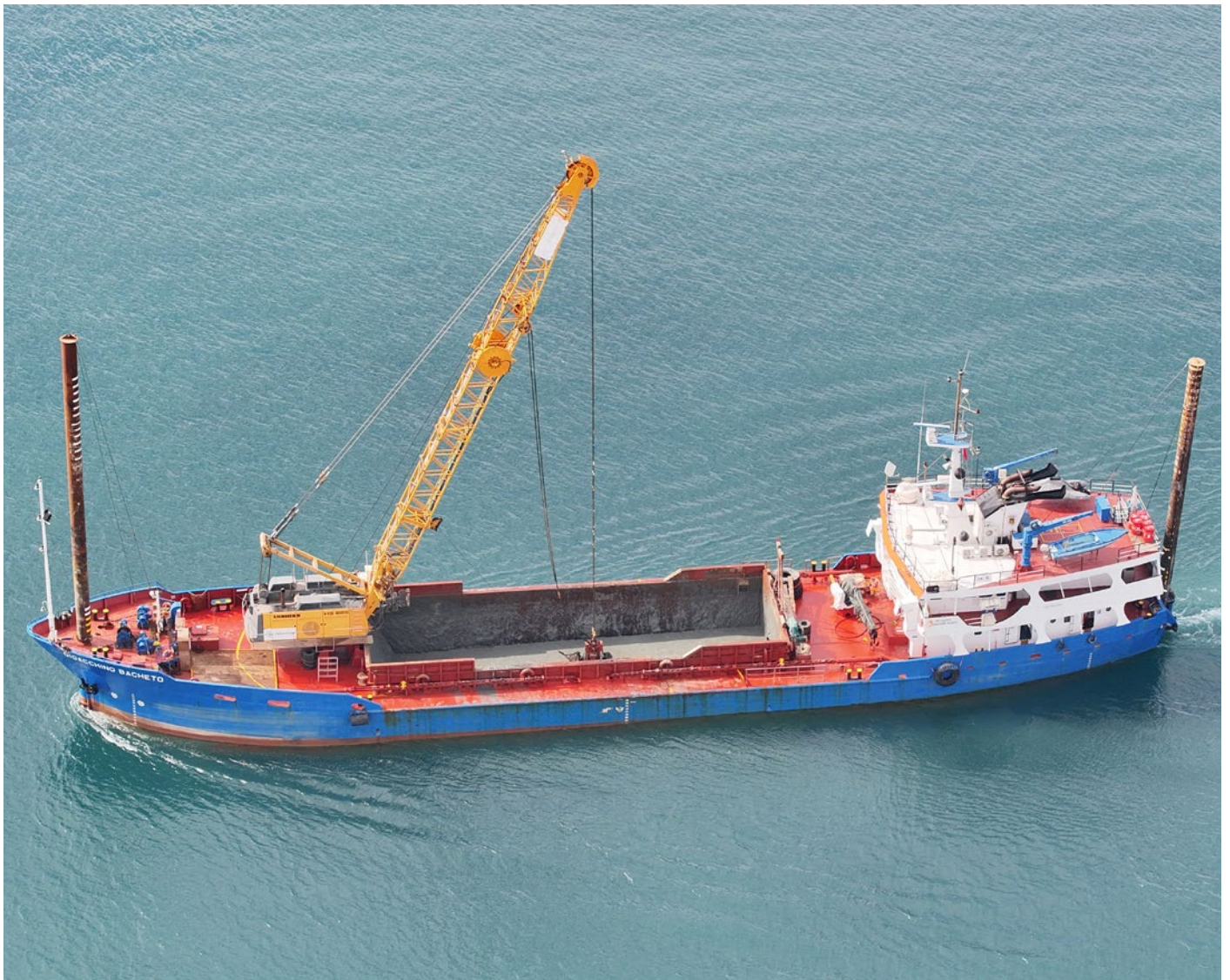
Premeščanje sedimenta je potekalo z ladjo-bagrom, ki omogoča natančno določanje mesta odlaganja. To je potekalo z grabilcem ali pa z odpiranjem dna ladijskega trupa.
