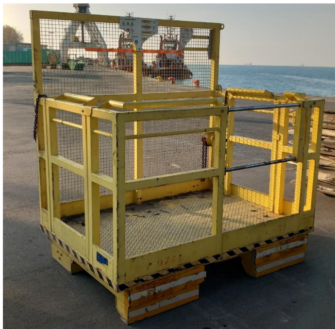
Slika 2: varnostna košara za delavce (obstoječa)
