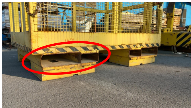
Slika 4: dvojni žepi za vilice različnih viličarjev (obstoječa var. košara)
