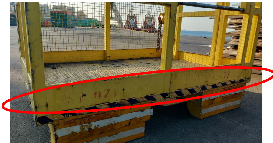
Slika 3: polni rob (okrog in okrog) nad podom varnostne košare (obstoječa var. košara)
