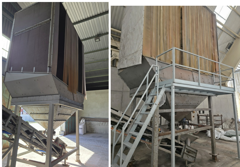
Slika 3: Lijak pri uvrečavalni napravi (kjer se nabira material) ter primer podesta (generirana slika)
