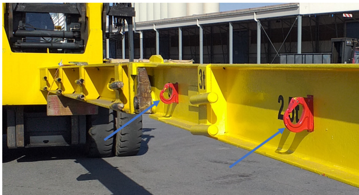
Slika 3 - Primer privarilnih kavljev na obstoječem trnu
