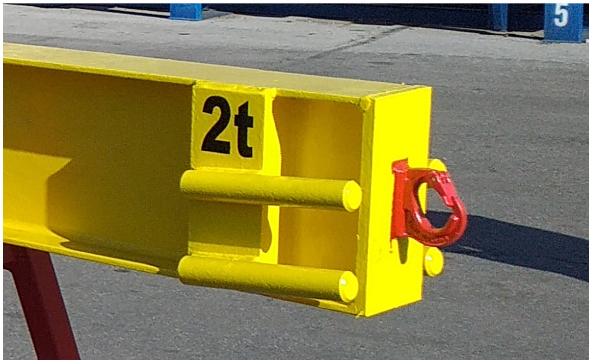
Slika 3 - Primer privarilnih kavljev na obstoječem trnu
