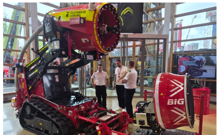
Gasilski robot za gašenje požarov in odvod dima na nevarnih in težko dostopnih območjih.
