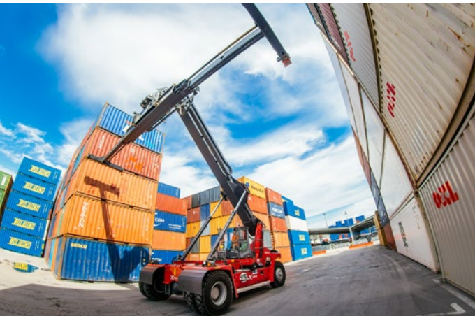
Eden od številnih manipulatorjev za prazne kontejnerje v akciji.
