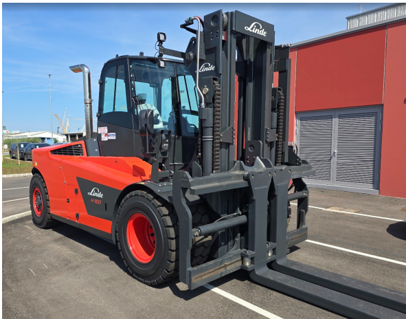
Slika 3: Viličar LINDE H160/1200 – z dimenzijami vilic
